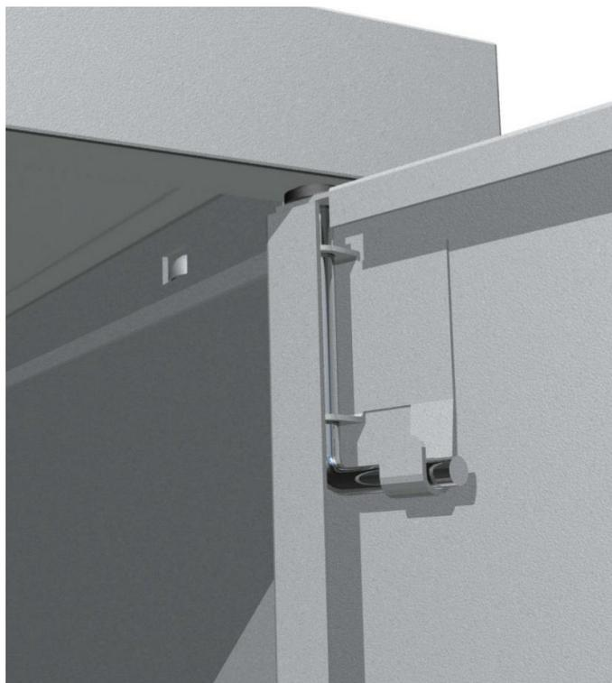
16. Для установки замка снять гайку и шайбу крепления корпуса. Вставить корпус замка в соответствующее отверстие двери и зафиксировать его с помощью гайки с шайбой.
