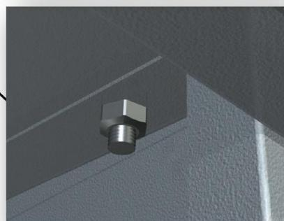
10. Установить полки , заведя их под верхнюю поверхность фасада и надев на соответствующие крючки на боковых стенках и перегородке. Прикрепить полки к перегородке и между собой с помощью винта с гайкой. (В шкаф ШРМ-24.0 устанавливаются еще 4 дополнительные полки. Дополнительные полки винтами между собой не скрепляются.)
