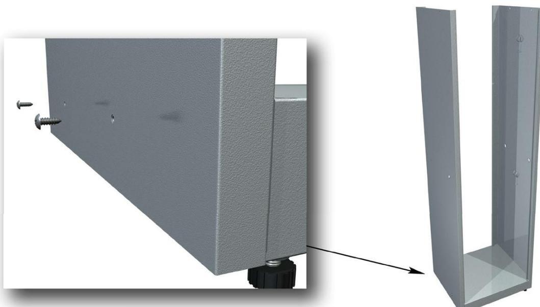
5. Установить заднюю стенку, соединив ее с боковыми стенками с помощью шести саморезов. Отбортовка на узкой стороне задней стенки должна располагаться снизу.
