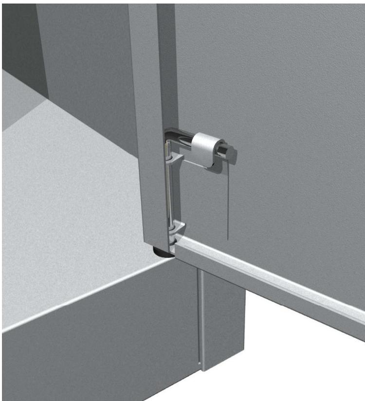
15. Совместить отверстия в верхней части двери с отверстием втулки крыши (или фасада), вставить ось и зафиксировать ее, загнув лепесток кронштейна.
