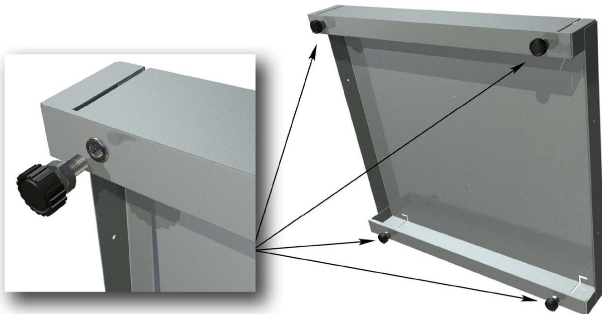
2. Установить дно на плоскую ровную горизонтальную поверхность. Установить правую боковую стенку, вставив ее в соответствующие пазы в дне.
