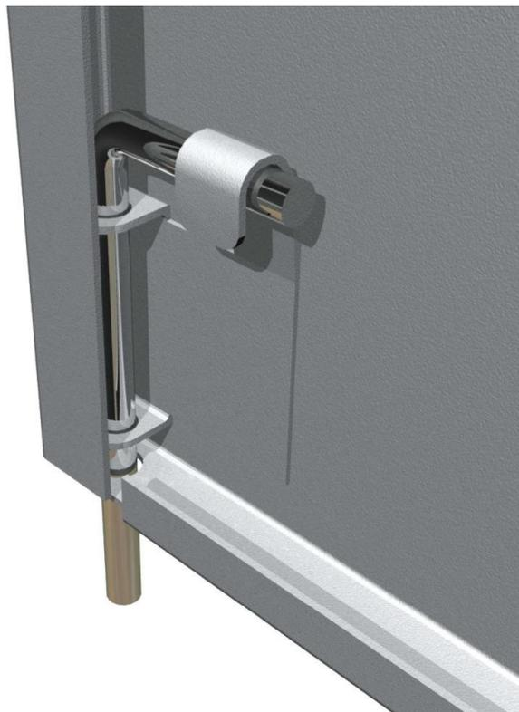
14. Вставить дверь осью в отверстие втулки дна (или фасада).
